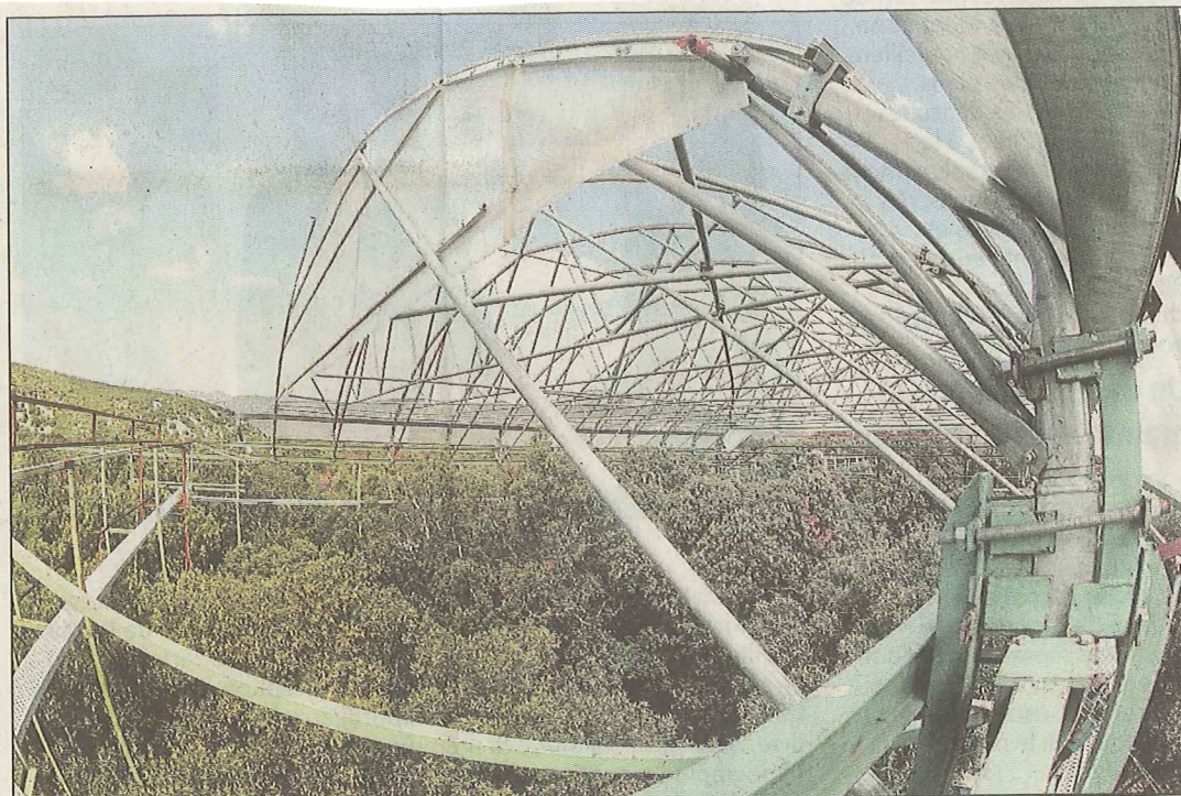
Un couvercle bâché situé à 15 mètres au-dessus des chênes permet de limiter l'apport en eau. D. Q.
