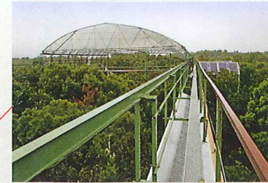
→ Ce toit mobile, dans la forêt de Puéchabon, permet de priver de pluie une parcelle d'arbres à étudier.
