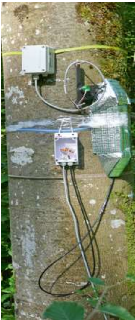
Gespickt mit Messgeräten: Datenlogger, Saftflussensoren (Mitte) und Banddendrometer liefern detaillierte Daten. Foto: A. von Ascheraden
