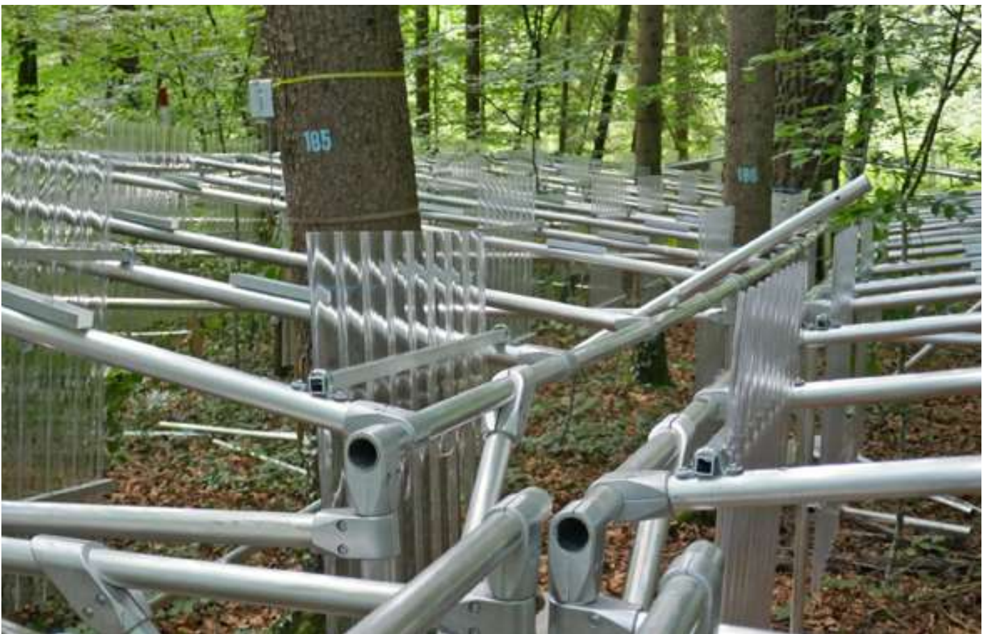
Sieben Dächer halten Teile des Regens ab und müssen die Baumstämme integrieren. Hier in geöffnetem Zustand.
