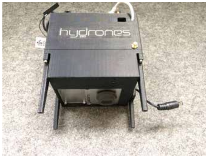
Figure 2 : Prototype HyDrones #MK2 dédié à la bathymétrie
